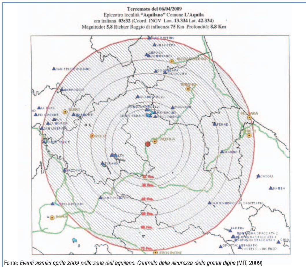
Figura 1: Ubicazione delle grandi dighe interessate dai controlli a seguito dell'evento principale
