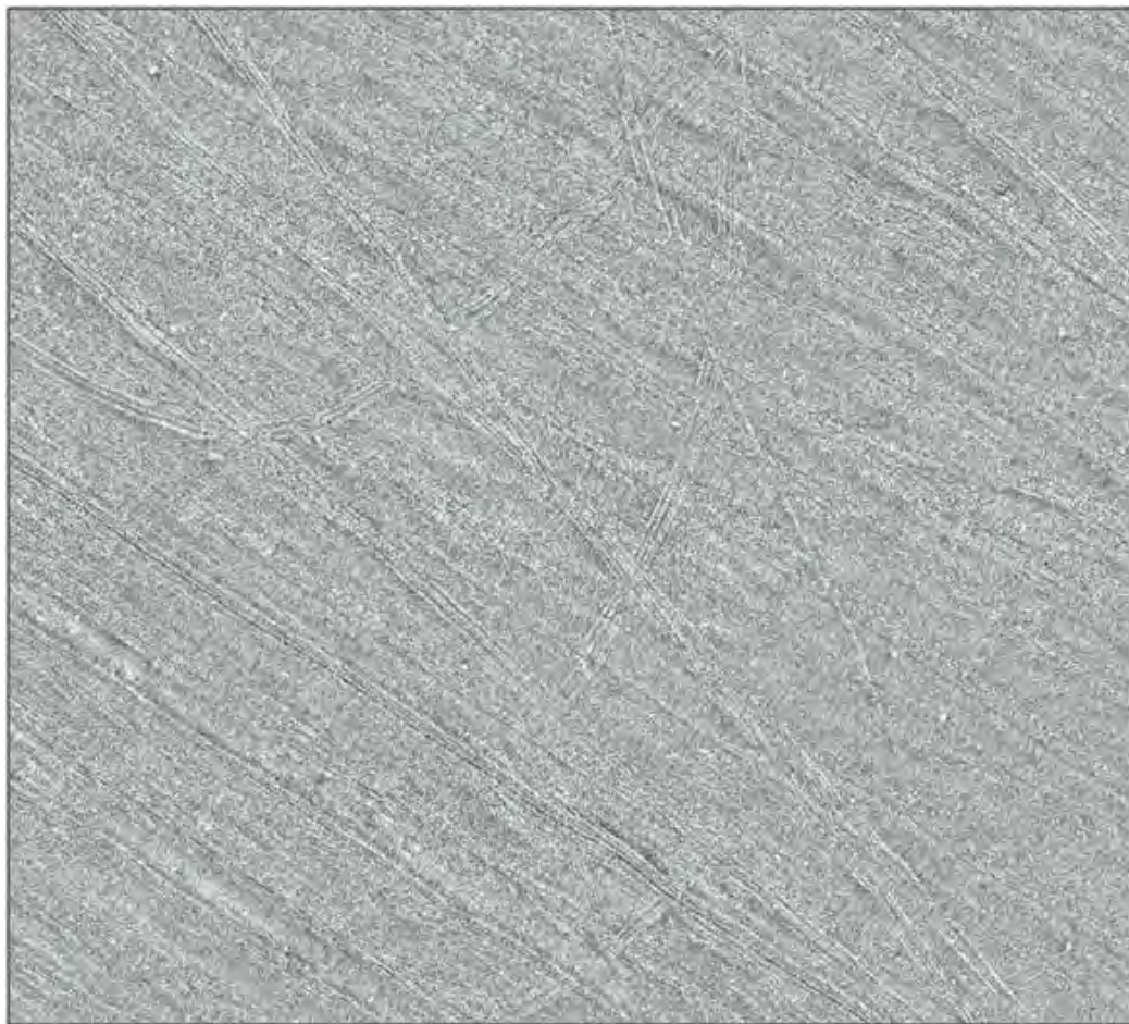
Figura 1: mappatura SSS di un'area 5x5 km con visibili tracce di pesca a strascico
