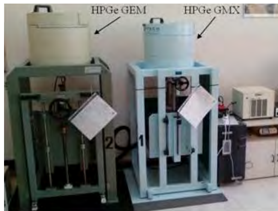
Figura 2: Setup sperimentale per le analisi di spettrometria gamma
