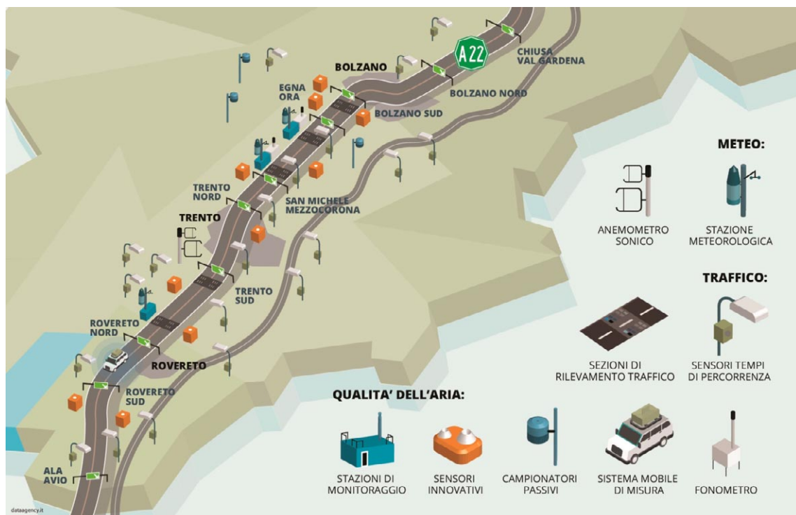
Figura 1: I sistemi di monitoraggio del progetto BrennerLEC
