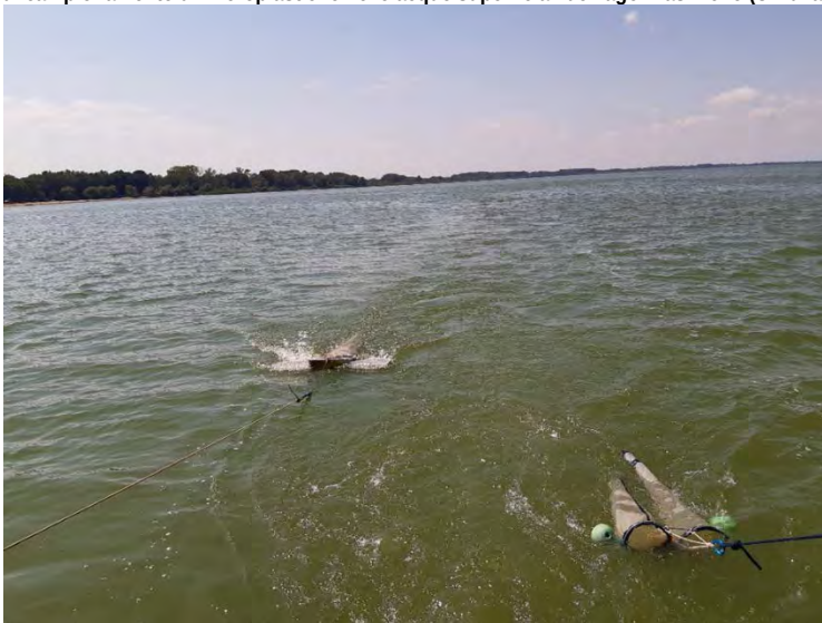
Figura 1: Fasi di campionamento di microplastiche nelle acque superficiali del lago Trasimeno (Umbria)
