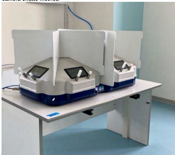
Figura 2: Olfattometro e camera olfatto metrica
