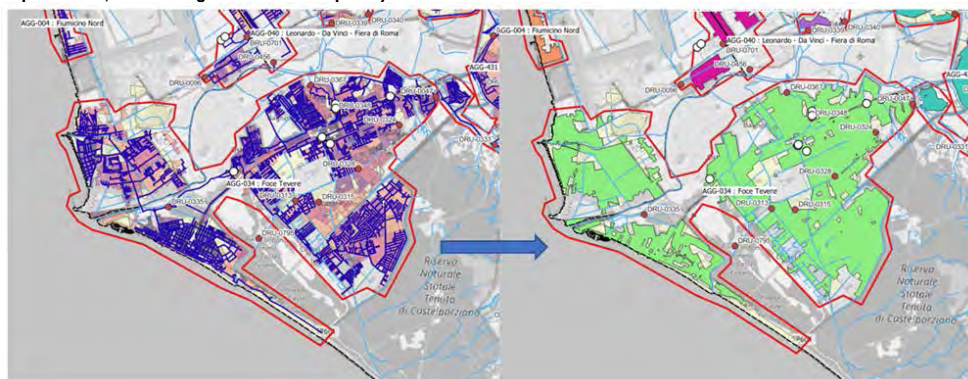
Figura 1: Individuazione di un agglomerato di acque reflue urbane (in blu le fognature, in rosso gli impianti di depurazione, in bianco gli scolmatori di piena)
